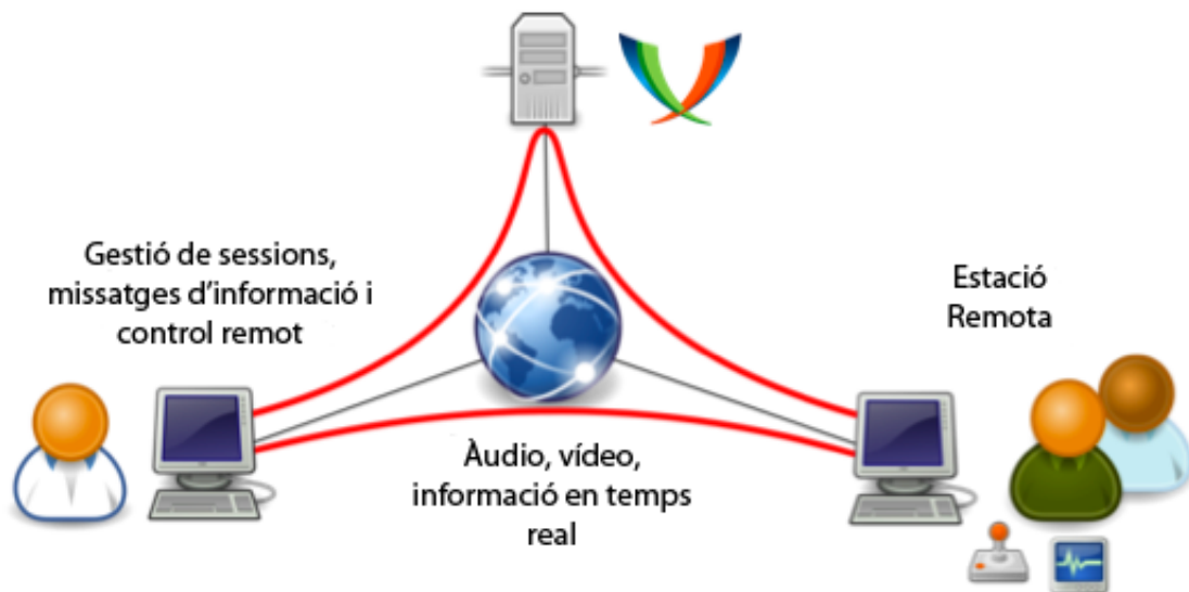
Figura 1.4: Arquitectura híbrida utilitzada en el TRiEM.
