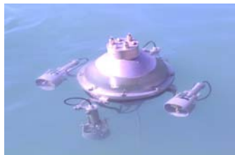
URIS: Robot Autonom Submarí (UdG)
